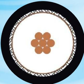
und ein darüberliegendes Kupfergeflecht sorgen für ein hohes Schirmmaß von > 90 dB bei 1 GHz. Der schwarze PVC-Außenmantel von Ecoflex 15 Plus ist UV-stabilisiert. Zur Vereinfachung der Installation wurden lötfreie Stecker der Normen N, UHF und 7-16 DIN entwickelt, die optimale Kontaktierung bieten sowie einfach und ohne Spezialwerkzeuge in kurzer Zeit konfektioniert werden können.
