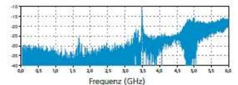
Bedingt durch Fertigungstoleranzen kann der Verlauf der Rückflussdämpfung variieren! Einzelne Spitzen sind unkritisch!
